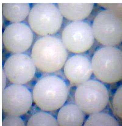
Rys. 2. Obraz z mikroskopu optycznego granulatu nitrocelulozowego ułożonego na płaszczyźnie.
