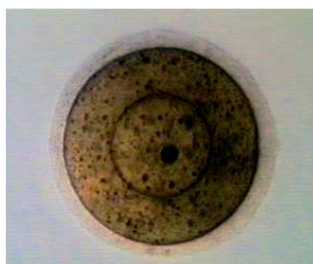
Rys. 5 Granice penetracji DEDGN w granuli NC.
