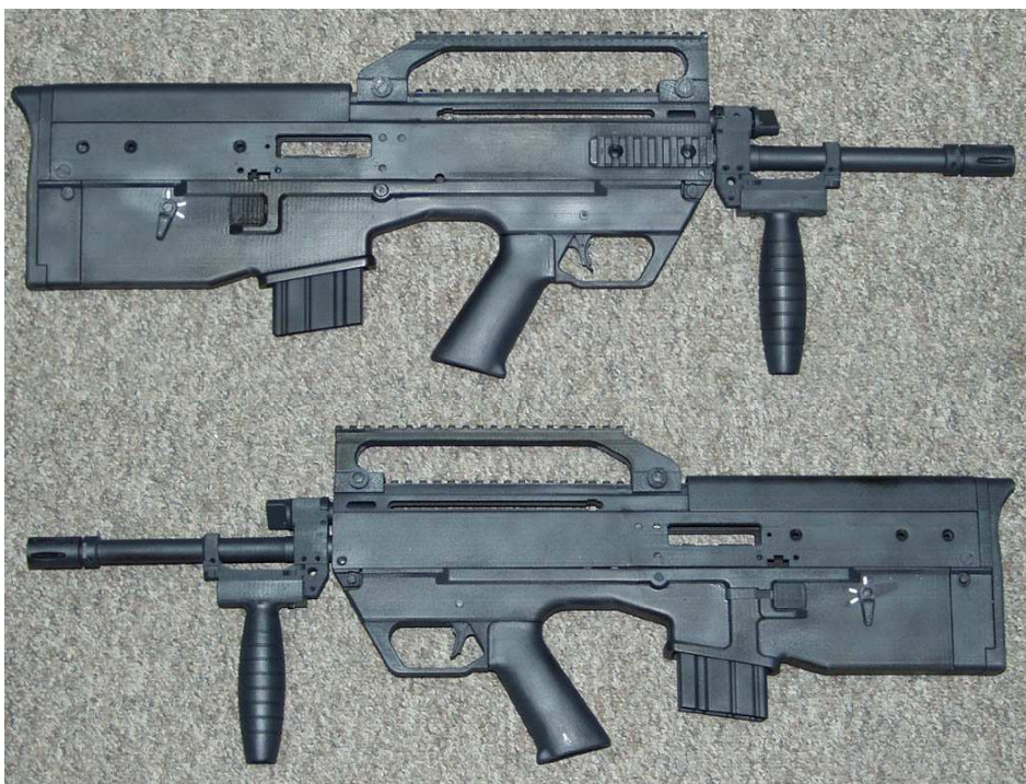
Fot. 9. Makieta nowoprojektowanego karabinka kalibru 5,56 mm zbudowanego w bezkolbowym układzie konstrukcyjnym: widok z prawej (górną) i lewej strony (dół)
