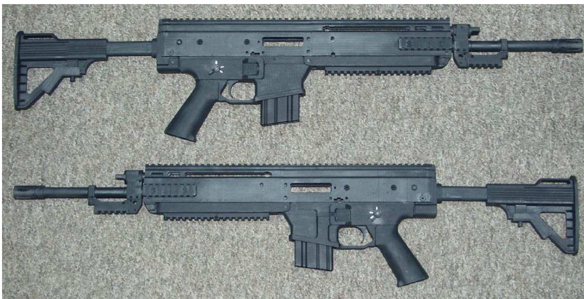
Fot.7. Makieta nowoprojektowanego karabinka kalibru 5,56 mm zbudowanego w klasycznym układzie konstrukcyjnym: widok z prawej (górną) i lewej strony (dół)
