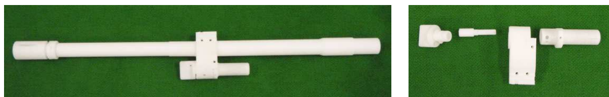
Fot. 5. Makieta zespołu lufy (z lewej strony) wraz z trójpołożeniowym regulatorem gazowym (z prawej strony)
