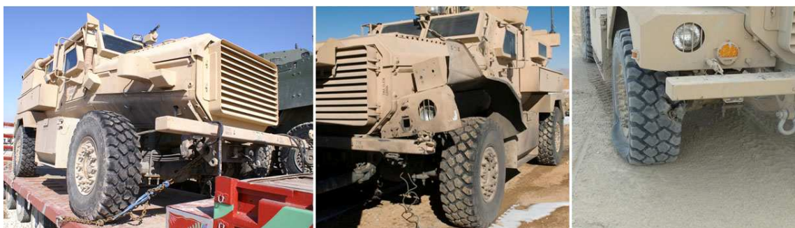
Fot. 5. Pojazdy uszkodzone wskutek wybuchu IED: Cougar z urwanymi błotnikami i uszkodzonymi instalacjami osi przedniej (z lewej i w środku) oraz zniszczone koło innego wozu (z prawej)
