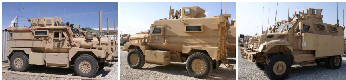
Fot. 6. Modernizacje pojazdów MRAP, od lewej: Cougar 4x4 z dodatkowymi pojemnikami oraz nowym oświetleniem, podwyższony Cougar 4x4, MaxxPro z opancerzeniem przeciw EFP
