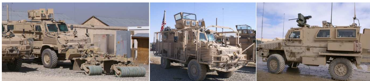
Fot. 7. Przykładowe kierunki modernizacji pojazdów klasy MRAP, od lewej: RG 31 z trałem przeciwmieinowym (możliwy jest też montaż trału na Cougarze), RG 31 z kratownicowymi osłonami przeciwko pociskom wystrzeliwanym z granatników przeciwpancernych, RG 33 z uzbrojeniem zamontowanym w zdalnie sterowanej wieży
