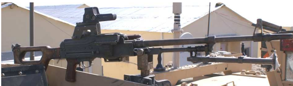
Fot.2. Karabin maszynowy PKM wyposażony w indywidualnym zakresie w podstawę do celownika HWS
