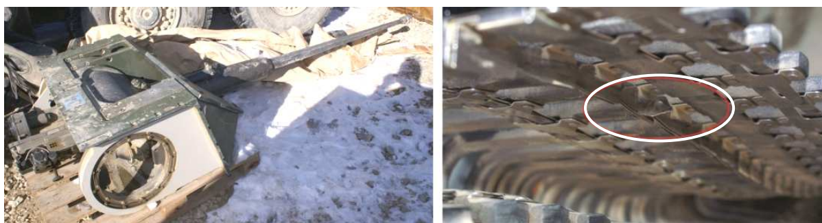
Fot.4. Armata Mk 44 oraz uszkodzony rękaw amunicyjny
