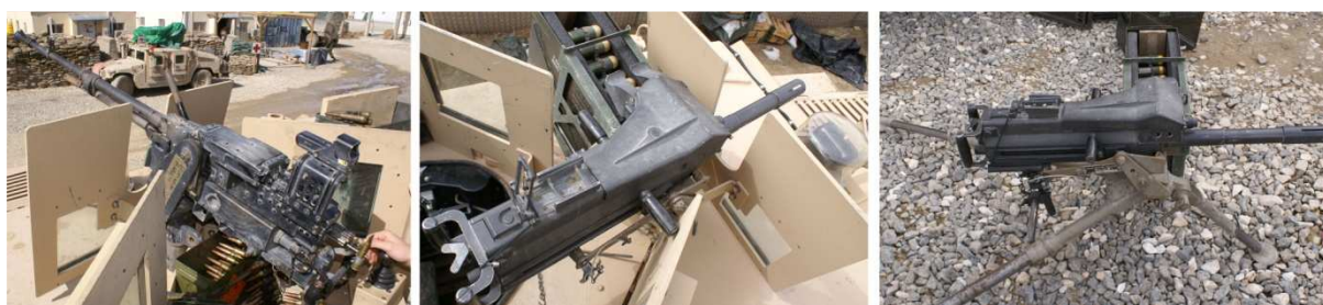
Fot.3. Wielkokalibrowy karabin maszynowy NSWT (na nabój 12,7x99 mm) oraz 40 mm granatnik automatyczny Mk 19 na pojeździe MRAP i na podstawie trójnożnej
