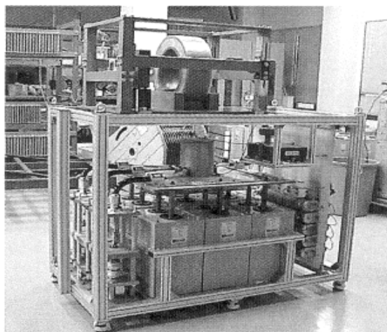
Rys. 6. Bateria kondensatorów o pojemn. 1236 \mu\text{F} , o energii 300 kJ
