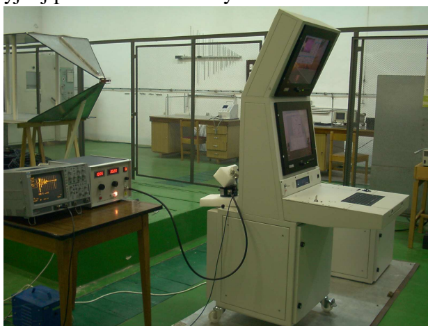
Rys. 3. Przykładowe badania odporności obwodów zasilania konsoli wielofunkcyjnej na ciągi impulsów quasiprostokątnych
