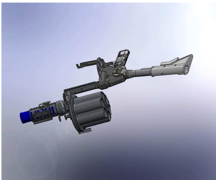
Rys.2. Granatnik RGP-40 w położeniu do ładowania, rozładowania i wyrzucania łusek
