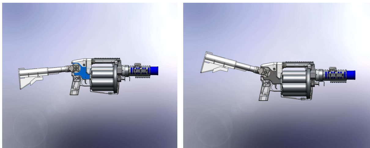
Rys.4. Granatnik RGP-40 z kolbą w położeniu do strzelania na odległości: do około 150 m (z lewej strony) oraz 150-350 m (z prawej strony)
