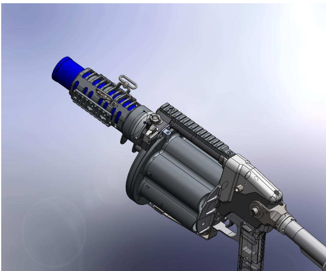
Rys.3. Granatnik RGP-40 z widocznym węzłem gazowym (widok z lewej strony)
