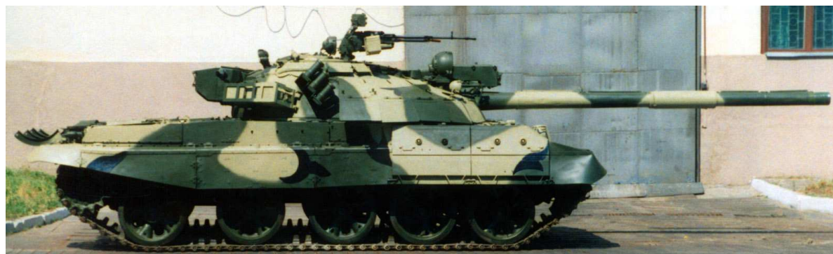
Rys.1.4. Sowiecki czołg T-62 uzbrojony w gładko lufową 115 mm armatę 2A20.
