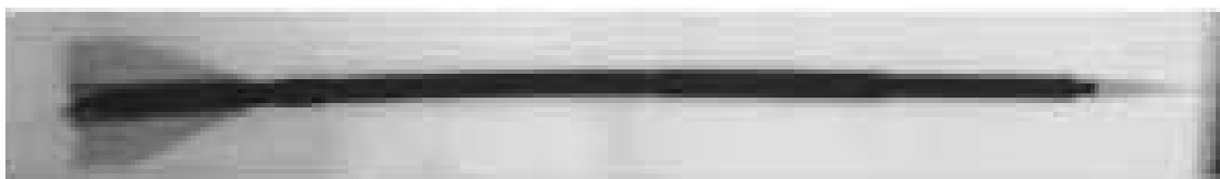
Rys.2.3. Ugięcie penetratora ( l/d=40 ) w odległości 20 m od wylotu lufy (fot. ISL).
