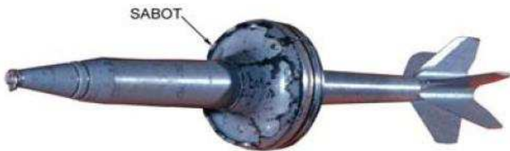
Rys.1.5. 125 mm przeciwpancerny rosyjski pocisk BM-15 typu APFSDS z sabotem typu pierścieniowego.
