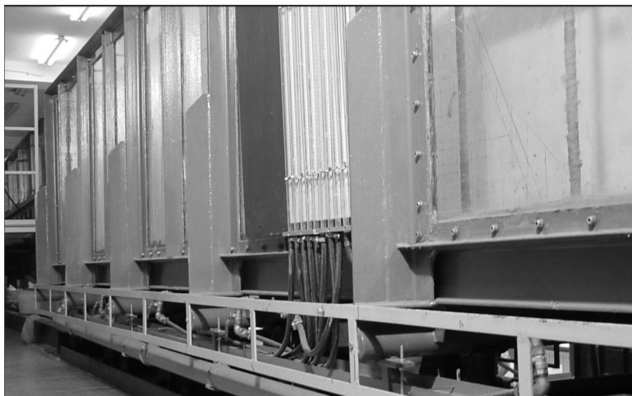
Rys. 1. Widok koryta hydraulicznego - średniowymiarowego aparatu do badania filtracji przez modele nasypów
