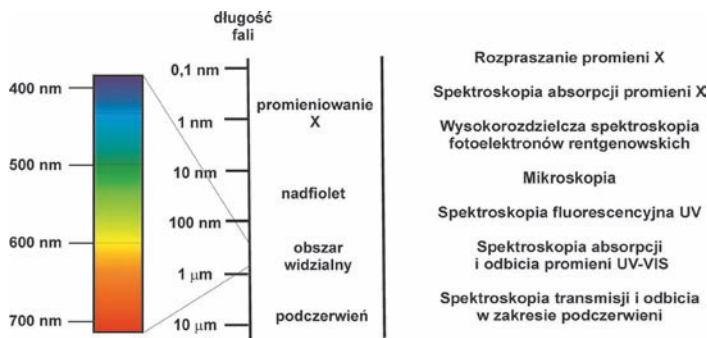
Rys. 2. Rozkład spektralny promieniowania synchrotronowego i wybrane techniki badawcze stosowane w różnych zakresach energetycznych
