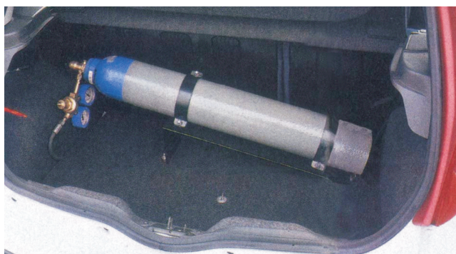
Rys. 1. Wysokociśnieniowa butla przeznaczona do transportu podtlenku azotu w bagażniku samochodu Fiat Punto [5]
