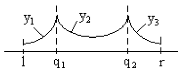
Rys. 5. Przykład ruchomego obiektu aproksymującego o strukturze łamanej (spline): y_1^{(0)} = y_2^{(0)} , y_1^{(m)} = w_{1m} y_2^{(m)} , y_2^{(0)} = y_3^{(0)} , y_2^{(m)} = w_{2m} y_3^{(m)} , w_{1m}, w_{2m} – stałe, j – numer węzła, m – numer pochodnej
