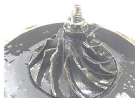
Fig. 7. Damage compressor impeller Rys. 7. Uszkodzony wirnik sprężarki
