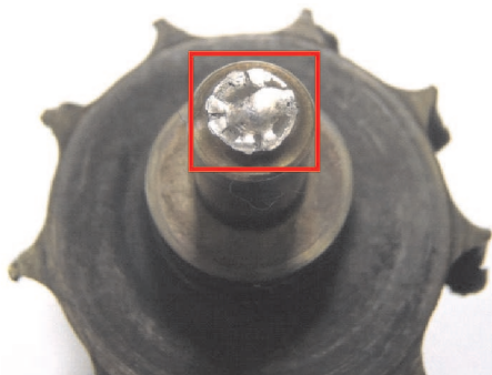
Fig. 11. Broken shaft: a) scale 1:1, b) scale 4:1
