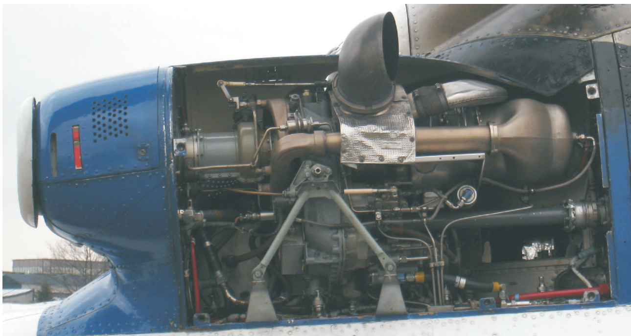
Fig. 2. Rolls-Royce Allison 250-C20B turbine engine mounted in the PZL Kania helicopter Rys. 2. Silnik turbinowy Rolls-Royce Allison 250-C20B zabudowany w śmigłowcu PZL Kania
