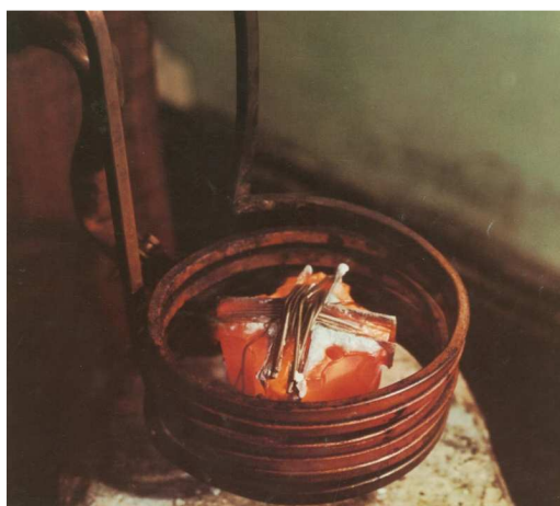
Rys. 7. Lutowanie indukcyjne koronki krzyżowej lutem w postaci drutu we wzbudniku pierścieniowym [10] Fig. 7. Induction brazing of cross-bit with wire brazing solder in loop inductor [10]
