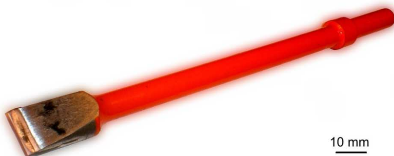
Rys. 5. Przykład narzędzia lutowanego płomieniowo – dłuto kamieniarskie o szerokości ostrza 16mm
