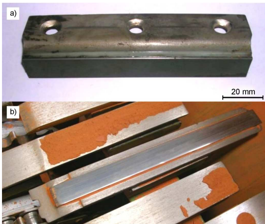
Rys. 4. Skrobaki węglkowe do czyszczenia taśm przenośników transportujących (a) oraz ślizgi transportowe (b) [2]
