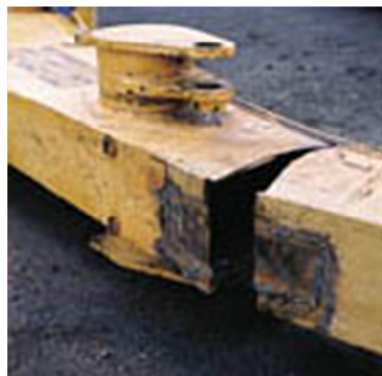
Rys. 10. Złamany wysięgnik koparki: a) widok ogólny wysięgnika, b) szczegół strefy złamania Fig. 10. Fractured boom: a) general view of the boom, b) close-up view of the boom
