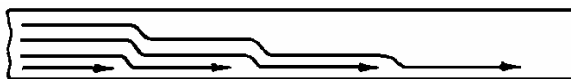
Rys. 1. Układanie spoiny wielowarstwowej systemem kaskadowym [3] Fig. 1. The fitting of a multi-layered weld bonding using cascading system [3]
