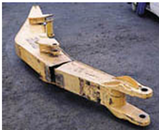
Rys. 10. Złamany wysięgnik koparki: a) widok ogólny wysięgnika, b) szczegół strefy złamania Fig. 10. Fractured boom: a) general view of the boom, b) close-up view of the boom
