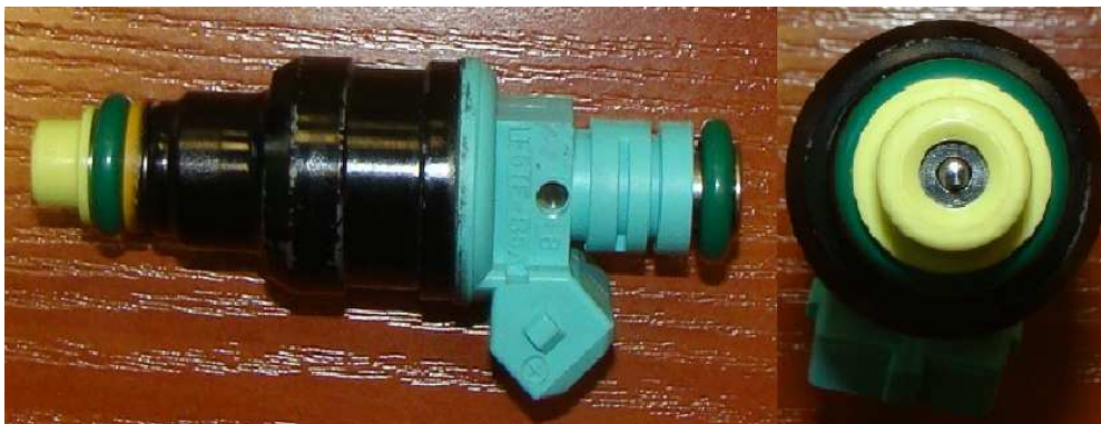
Rys. 4. Zawór gazu dozowanego do układu dolotowego silnika Fig. 4. Valve CNG injection in inlet engine
