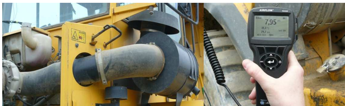
Rys. 2. Widok obudowy filtra powietrza i anemometru pomiarowego Fig. 2. View exterior air pre-cleaner filter and anemometer
