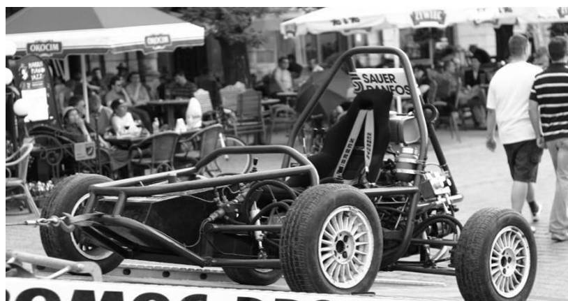
Rys. 3. Obiekt badań – pojazd prototypowy z napędem hydrostatycznym Fig. 3. Object of study - a test vehicle with hydrostatic drive
