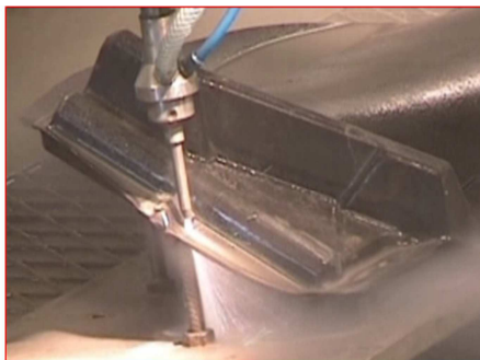
Rys. 5. Wycinanie wypłytki z odlewu łopatki turbiny [3] Fig. 5. Cutting burrs on turbine blades after casting [3]
