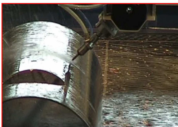
Rys. 2. Wycinanie otworów na profilu rurowym Fig. 2. Cutting holes for pipe profile
