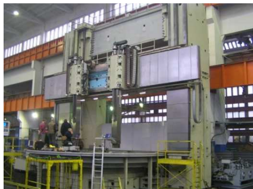
Rys. 2. Widok ogólny tokarskich centrów karuzelowych: a) typ - KCI-210/280 NM, b) typ - KCI-500/550 NM Fig. 2. General view of the turning and boring lathe centers: a) type - KCI-210/280 NM, b) type - KCI-500/550 NM
