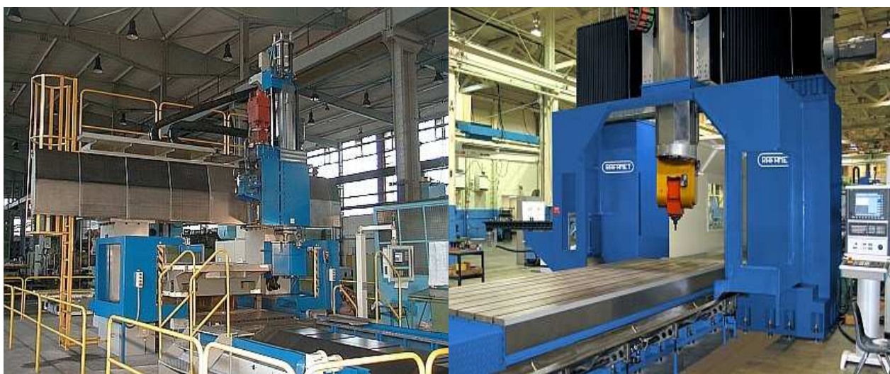
Rys. 6. Badane frezarki bramowej, po prawej FB 200 CNC, po lewej HSM 180 CNC [10] Fig. 6. Planer mills under study, FB 200 CNC on the right, HSM 180 CNC on the left [10]
