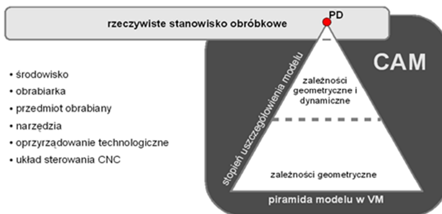
Rys. 1. Stopień szczegółowości modeli dla potrzeb obróbki wirtualnej. Modele uwzględniane w obróbce wirtualnej
