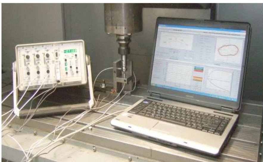
Rys. 2. Pomiar zmian położenia osi wirujących Fig. 2. Measurement of rotational axes position change
