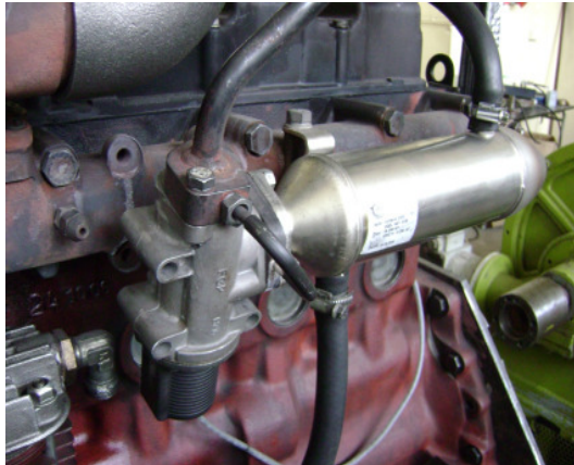
Rys. 7. Dwustanowy zawór EGR z kanałem obejściowym i chłodnicą recyrkulowanych spalin
