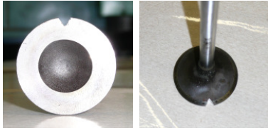
Rys. 1. Widok uszkodzonego zaworu
