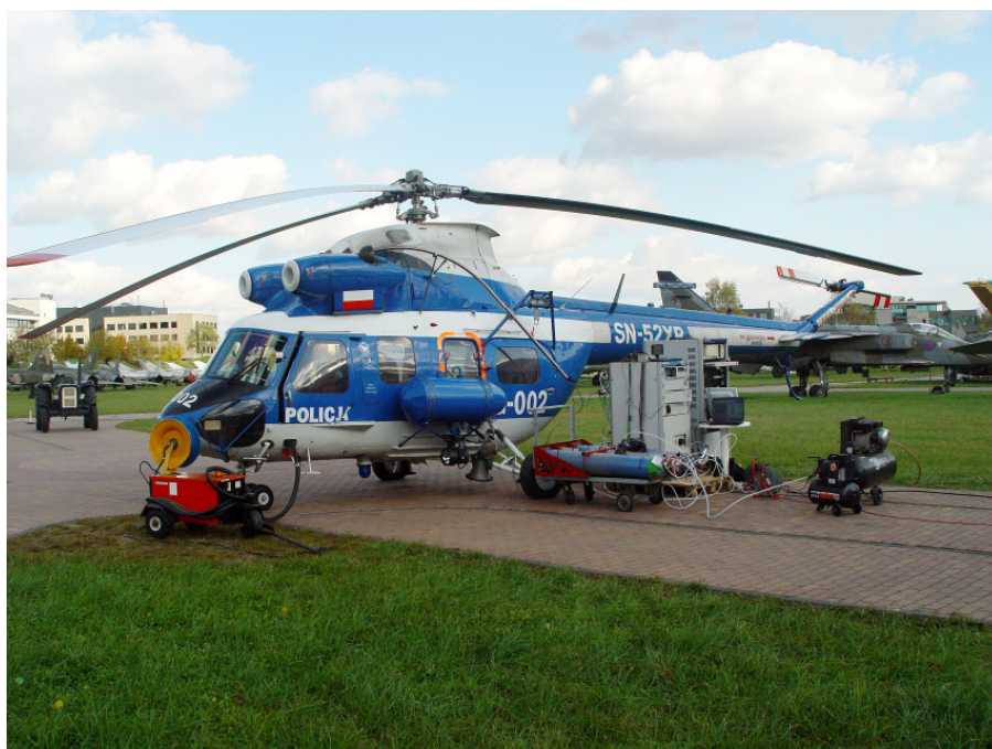
Rys.2.1. Widok stanowiska badawczego śmigłowca PZL Kania wraz z aparaturą pomiarową
