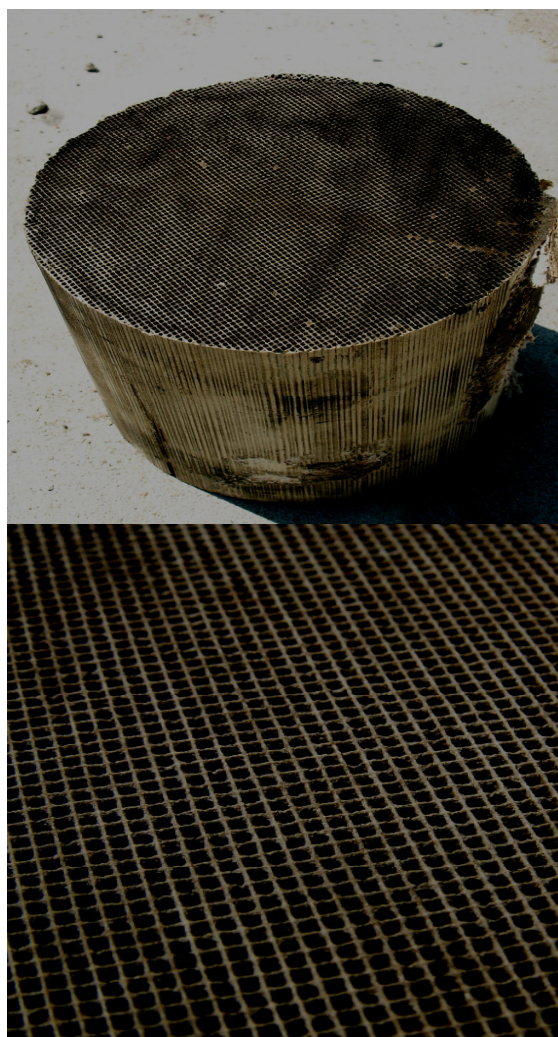
Rys.1. Osady zalegające wlotową stronę katalizatora
