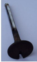
Rys.1. Uszkodzony zawór wylotowy (typ II)
