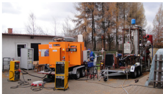
Fig. 5. The generating set connected to the gasification installation during the indication of the double-fuel engine Rys. 5. Zespół prądotwórczy podłączony do instalacji zgazowującej podczas indykowania silnika dwupaliwowego
