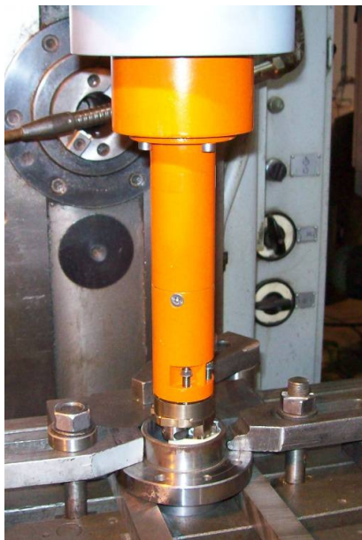
Rys. 16. Widok stanowiska obróbkowego z głowicą do mikrowygładzania oscylacyjnego cylindrów, typu GO-4 [2, 3, 4, 5]
