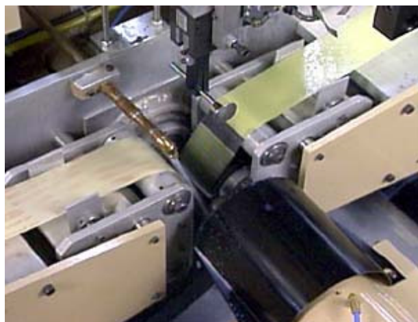
Rys. 11. Fotografia strefy obróbki podczas bezkłowego mikrowygładzania powierzchni trzonek zaworów silników spalinowych FTS [11]
