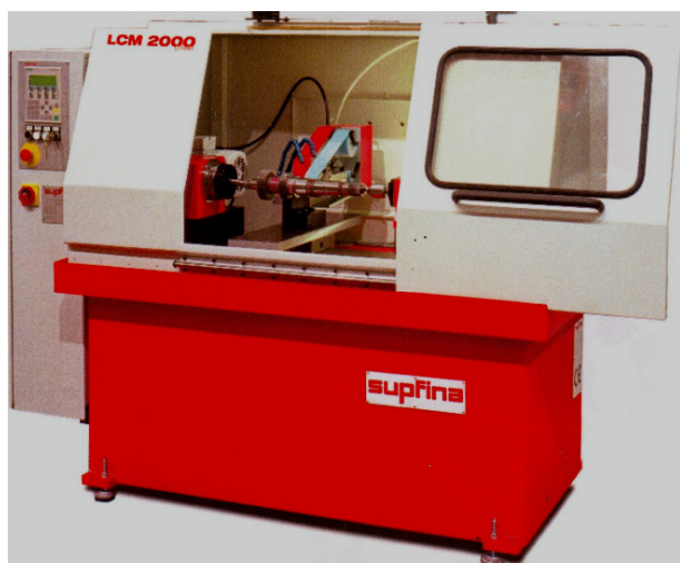
Rys. 10. Fotografia obrabiarki do mikrowygładzania powierzchni walcowych FTS [13, 14]
