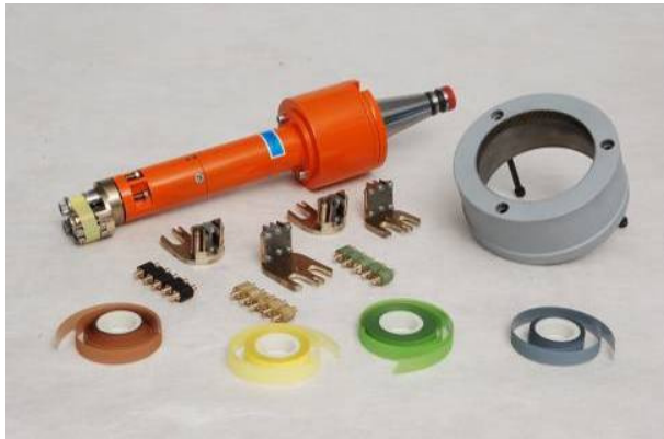
Rys. 15. Głowica do oscylacyjnego mikrowygładzania nieobrotowych cylindrów foliowymi taśmami ściernymi, typu GO-4 [2, 3]
