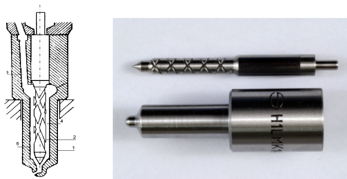
Rys. 1. Schemat i przykład wykonania wtryskiwacza wielootworowego ze wstępną termiczną – katalityczną – turbulizacyjną obróbką paliwa
