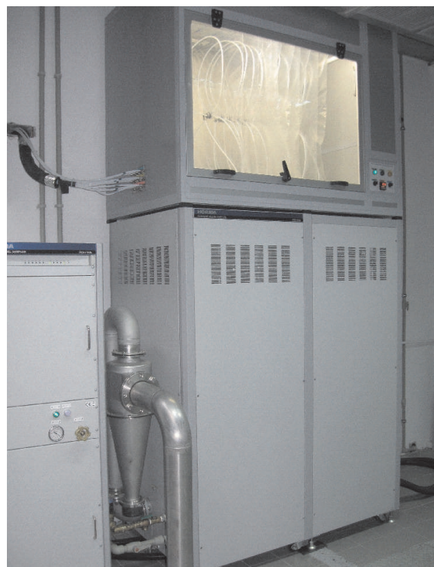
Fig. 8. Sample bags within insulated housing Rys. 8. Worki próbkujące w zaizolowanej szafie
