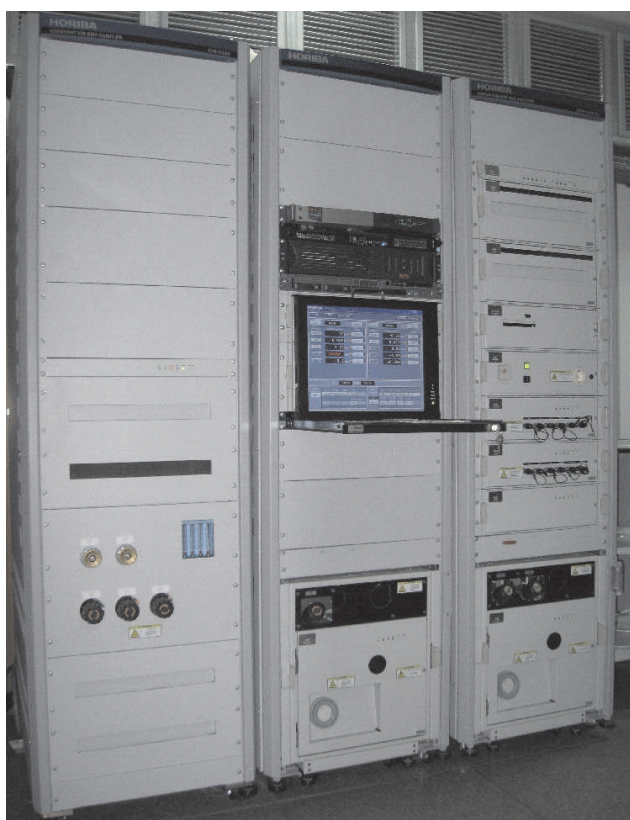
Fig. 7. 7400 HTRLE emissions analysis bench Rys. 7. Zestaw analizatorów spalin 7400 HTRLE
