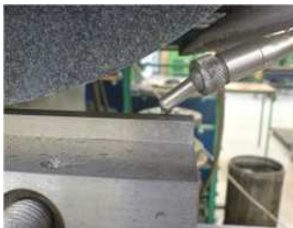
Rys. 3. Sposób ustawienia dyszy podającej ciecz obróbkową Fig. 3. Preparation of experimental stand to work
