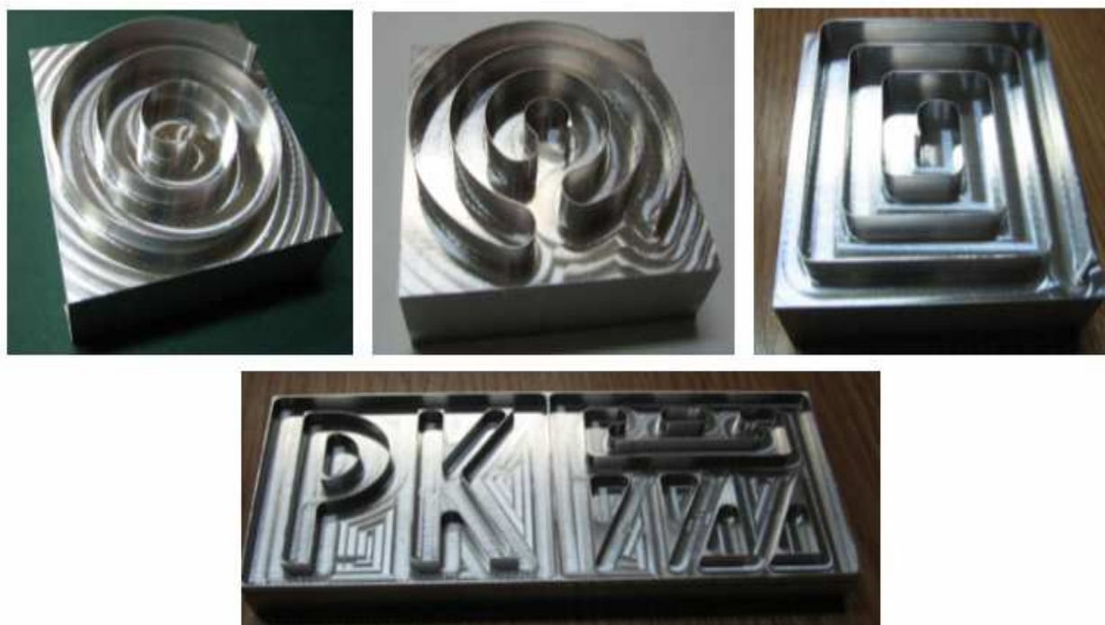
Rys. 10. Przykłady przedmiotów cienkościennych charakteryzujące się małymi błędami obróbki Fig. 10. Examples of thin-walled parts characterized by small machining errors
