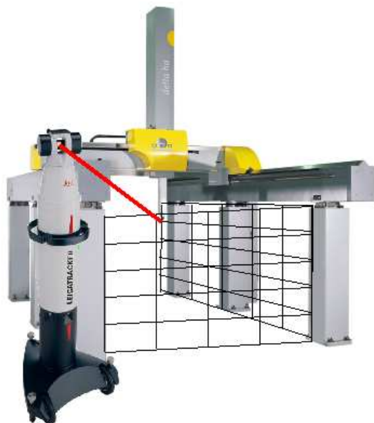
Rys. 5. Realizacja metody macierzowej z wykorzystaniem Laserowego Systemu Nadążnego LSW 840 Leica Fig. 5. Realization of Matrix Method with the use of Lasertracker LTD840 Leica
