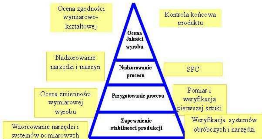
Rys. 1. Technologie pomiarowe w inżynierii produkcji Fig. 1. Measuring technologies in production engineering
