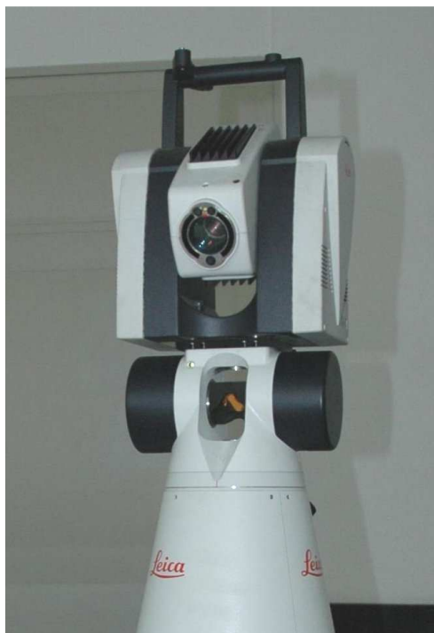
Rys .2. Laserowy system nadążny firmy Leica Fig. 2. Leica Laser Tracker
