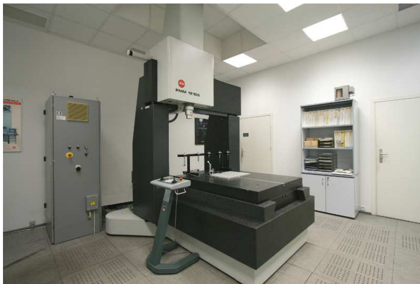
Rys. 3. Współrzędnościowa Maszyna Pomiarowa PMM12106 Fig. 3. Coordinate Measuring Machine PMM12106
