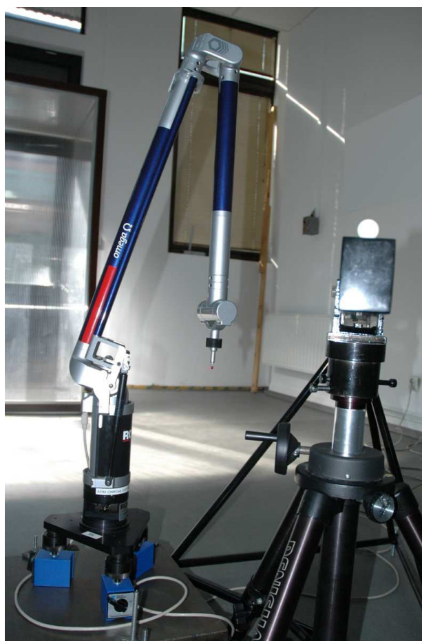
Rys. 4. Współrzędnościowa Ramie Pomiarowe firmy Romer Fig. 4. Romer Portable Measuring Arm
