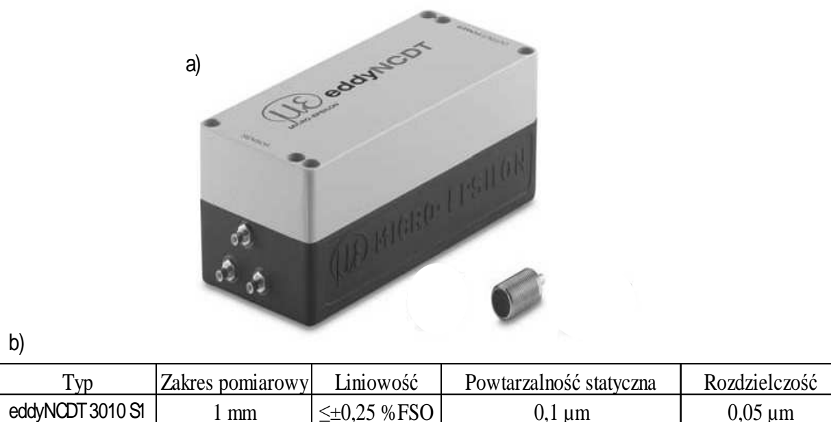
Rys. 3. Czujnik wiropądowy eddyNCDT 3010; a) czujnik wraz ze wzmacniaczem; b) charakterystyka czujnika [5]
