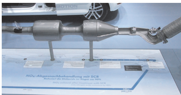
Rys. 9. Reaktor SCR silnika 2.0 BlueTDI [5]
