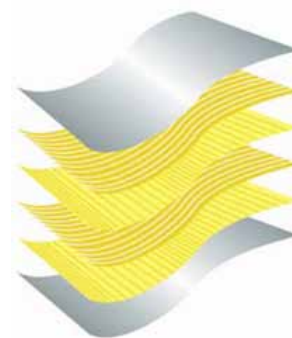
Rysunek 10. Budowa balistycznego materiału kompozytowego Gold Flex ® [31]
