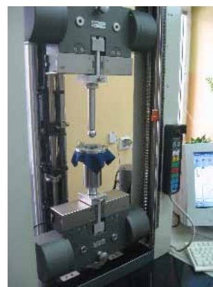
Rysunek 1 - Widok stanowiska laboratoryjnego do badania wytrzymałości na przebicie kulką
