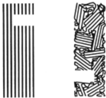
Rys. 4. Struktura włókna Dyneema ® i standardowego włókna polietylenowego [20]
