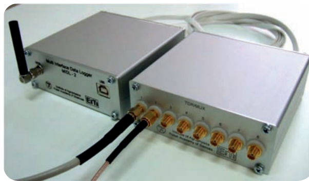
Rys. 4. Elementy telemetrycznej stacji monitoringu wilgotności, temperatury i zasolenia gleby: ośmiokanałowy miernik TDR typu TDR/MUX/mpts oraz modem GPRS typu MIDL-2
