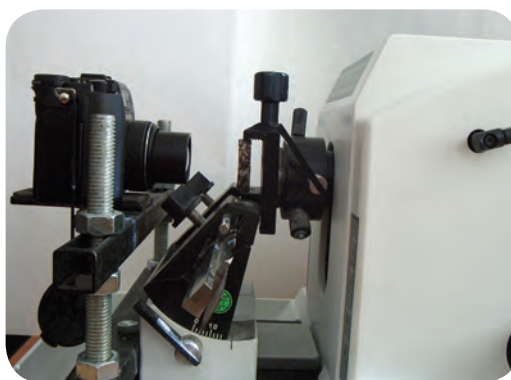
Rys. 3. Stanowisko badawcze: a – mikrotom, b – sposób zamocowania aparatu
