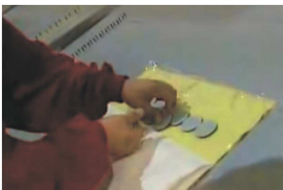
Rys. 2. Sposób układania krążków kompozytowych [1]
