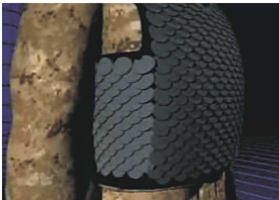
Rys. 5. Rozmieszczenie krążków kompozytowych w kamizelce Dragon Skin® [1]
