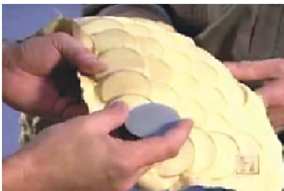
Rys. 1. Wkład kamizelki Dragon Skin® i krążek kompozytowy [1]
