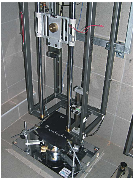
Rys. 3. Stanowisko do badania właściwości amortyzacyjnych ochraniaczy przeciwdrożeńowych w Instytucie Technologii Bezpieczeństwa „Moratex”
