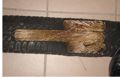
Rys. 2. Opona po obróbce metodą Water-jet Fig.2. The tire after machining using Water-jet method
