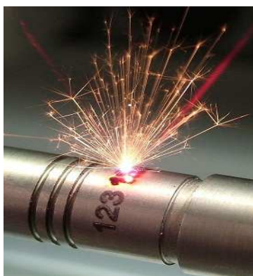
Rys. 1. Laserowe grawerowanie elementu stalowego [2]
