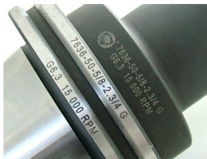
Rys. 2. Laserowe znakowanie trzpienia frezerskiego [2] Fig. 2. Laser marking of the flange tooling [2]
