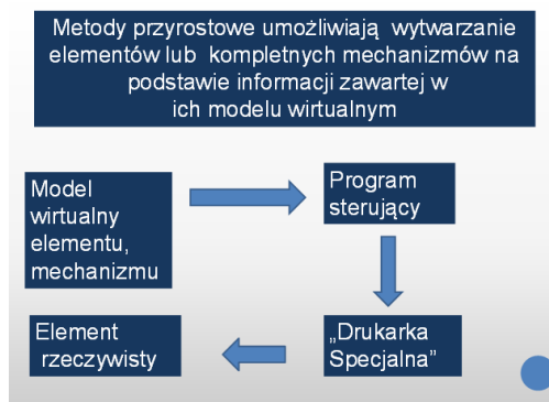
Rys. 5. Schemat wytwarzania przy użyciu metod przyrostowych Fig. 5. Scheme of manufacturing by additive methods
