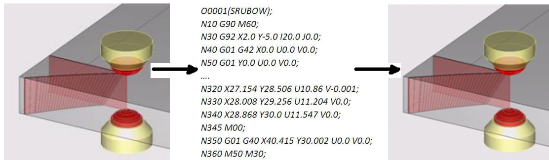
Rys. 5. Zasada pracy oprogramowania uwzględniającego skorygowane współrzędne w programie obróbki: współrzędne (x, y, u, v) w programie obróbkowym \Rightarrow Pomiary przedmiotów testowych w przekrojach i w strefach po obróbce testowej \Rightarrow Korekta programu NC \Rightarrow Obróbka według współrzędnych poprawkowych (x', y', u', v')
