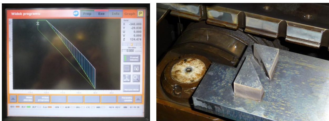
Rys. 2. Obróbka próbek metoda WEDM: a) widok ekranu układu sterowania jednej z zastosowanych wycinarek FI444SLP, b) widok próbek z fortalu po ich wytworzeniu na innej wycinarce ROBOFIL 290
