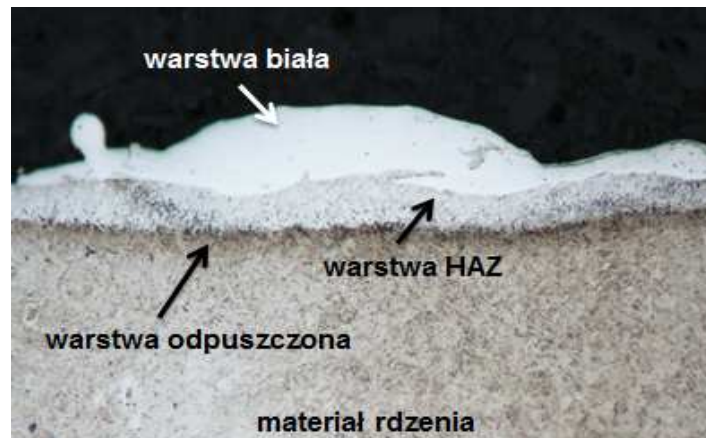
Rys. 1. Mikrostruktura powierzchni po obróbce elektroerozyjnej Fig. 1. The microstructure of the surface after EDM
