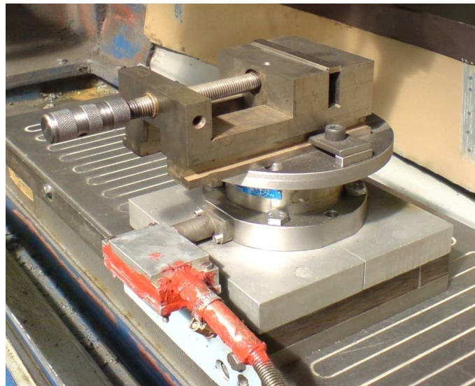
Rys. 2. Stanowisko badawcze, sposób mocowania próbek na siłomierzu Fig. 2. Experimental station, the method of mounting samples on a dynamometer
