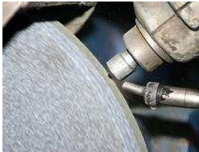
Rys.4. Sposób przygotowania stanowiska do pracy: regeneracja czynnej powierzchni ściernicy Fig.4. Preparation of experimental stand to work: regeneration of active surface of the grinding wheel
